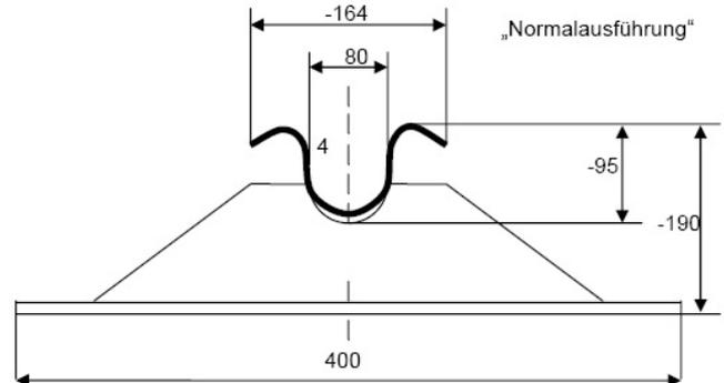
Es empfiehlt sich, speziell die Ankerleisten mit Steinen zu beschweren bzw. die gesamte Wasserspule mit Strassenmaterial sorgfältig zu hinterfüllen und zu verstampfen. Es ist beim Verlegen darauf zu achten, dass die Wasserspulen-Oberkante etwa 2-3 cm unterhalb des Strassenniveaus zu liegen kommt.
