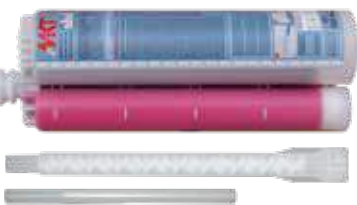
Kartusche VME 585 Side-by-side Kartusche Inhalt: 585ml Mit großem Mischer VM-XL und Reduzier-/Verlänge- rungsrohr für Bohrlöcher ab 12mm Durchmesser
