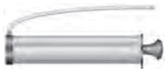
➔ Zum bewerkungskonformen Ausblasen von Bohrlöchern in Mauerwerk sowie in Beton bis 20 mm Durchmesser und maximal 240 mm Bohrtiefe (VM-EA)
