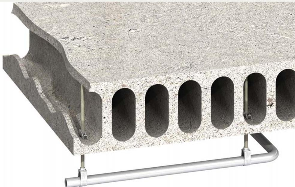
L'écrou rotule est conçu pour la suspension des conduites générales à partir de dalles creuses de béton pré-moulé (profondeur minimum 75 mm) et aussi à partir de profilés creux, de tôles d'acier ou de pannes.
