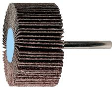
Die Lamellen aus Schleifmittel auf Unterlage sind fächerförmig radial um die Achse des Werkzeuges angeordnet. Durch ihre Flexibilität passen sie sich ideal den Konturen des Werkstückes an. Das Schleifkorn ist in eine Kunstharzbindung auf dem flexiblen Gewebeträger eingebettet.
